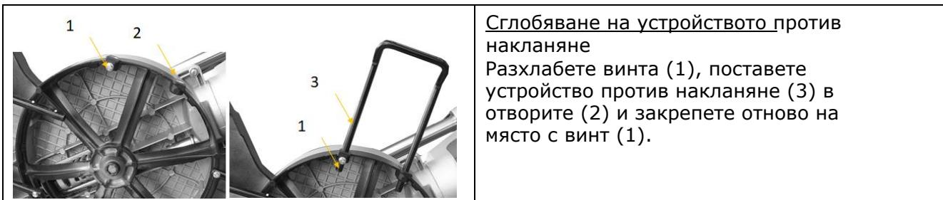
Сглобяване на устройството против накланяне
