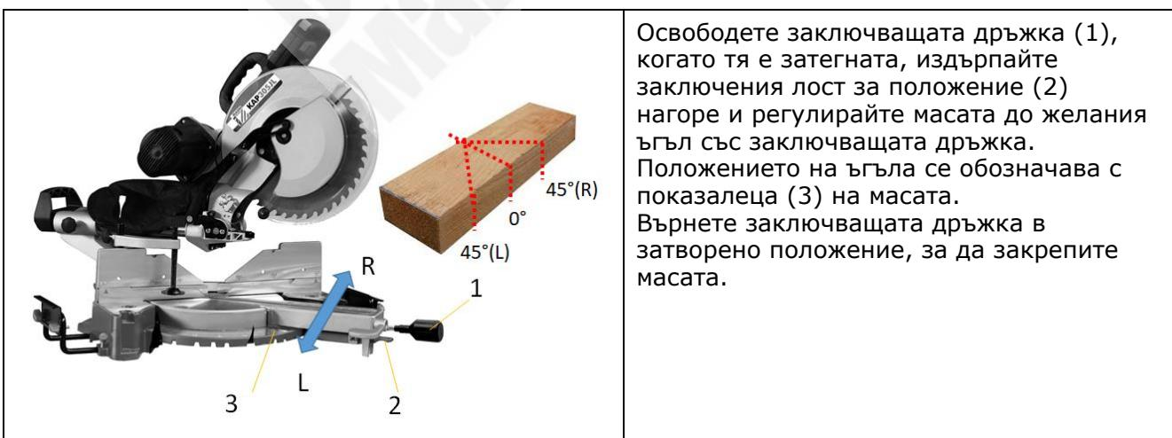
Освободете заключващата дръжка (1), когато тя е затегната, издърпайте заключения лост за положение (2) нагоре и регулирайте масата до желания ъгъл със заключващата дръжка. Положението на ъгъла се обозначава с показалеца (3) на масата. Върнете заключващата дръжка в затворено положение, за да закрепите масата.
