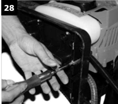
BG Поставете машината настрани, двигателя нагоре и отстранете две гайки M6 с шайби и два винта M5 с шестостен с шайби отдолу с гаечен ключ 10.
