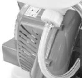
BG Отстранете гайката на дренажната капачка от дясната страна на резервоара за пръскане.
