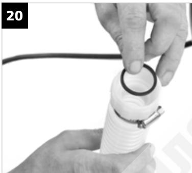
BG Поставете маркуча със съединителната гайка в гъвкавата тръба и го закрепете със скоба за маркуч. Поставете уплътнението в капачната гайка и го монтирайте върху дренажа на резервоара от дясната страна на машината.
