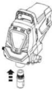
7. Appuyer sur le tuyau de retour sur le raccord du tuyau de retour. Pincer l'attache sur le raccord du tuyau de retour pour fixer le tuyau de retour.
