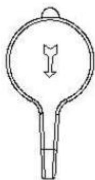
5. Заключете пистолета за пръскане. Уверете се, че седлото и черното уплътнение са на мястото си в предпазителя на върха (вижте Части и описание, страница 5). Завийте предпазителя на пръскания накрайник върху пистолета. Затегнете на ръка.
