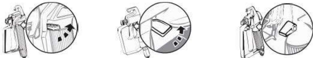
2. Drehen Sie den Vorfüll / Sprüh Knopf auf vorfüllen Schalten Sie die Pumpe aus (O). Ziehen Sie den Stecker aus der Steckdose.
