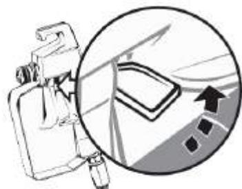
Pour verrouiller le pistolet, tourner le verrou de la gâchette en avant et légèrement vers le bas jusqu'à ce qu'il s'arrête.
