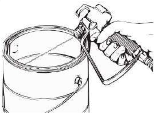
**Si le bouton PRIME / SPRAY est toujours sur SPRAY, il y aura une forte pression dans le tuyau et le pistolet pulvérisateur jusqu'à ce que le bouton PRIME / SPRAY soit placé sur PRIME.**
