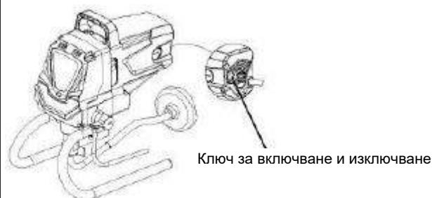
2. Включете захранващия кабел в заземен контакт или силно заземен удължителен кабел. Поставете щепсела в удължителния кабел. Вижте важна електрическа информация,
