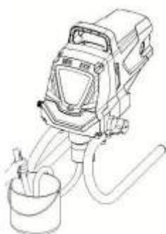
2. Завъртете копчето PRIME / SPRAY на PRIME. Включете пръскачката. Поставете превключвателя на ON (A).
