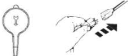
3. Drehen Sie den Vorfüll / Sprüh Knopf auf Sprühen. Testen Sie das Sprühgerät an einem Übungsstück und beginnen Sie mit dem Sprühen.
