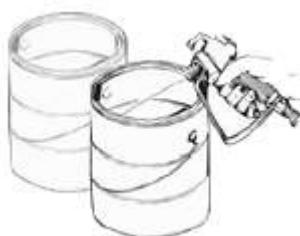
4. Quand la solution nettoyante sort du pistolet pulvérisateur, continuer à maintenir la gâchette et viser le côté du conteneur à déchets avec le pistolet pulvérisateur (**mettre le pistolet à la terre avec un conteneur métallique si vous vidangez avec un solvant inflammable**).
