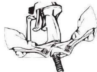
6. Enfiler le tuyau d'aspiration sur la soupape d'admission et serrer fermement à la main.
