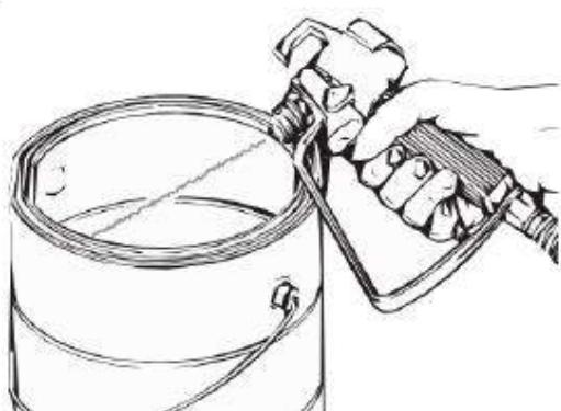
**Wenn der VORFÜLL / SPRÜH Knopf noch auf SPRÜH steht, herrscht Hochdruck im Schlauch und in der Sprühpistole, bis der VORFÜLL / SPRÜH Knopf auf VORFÜLLEN gedreht wird**
