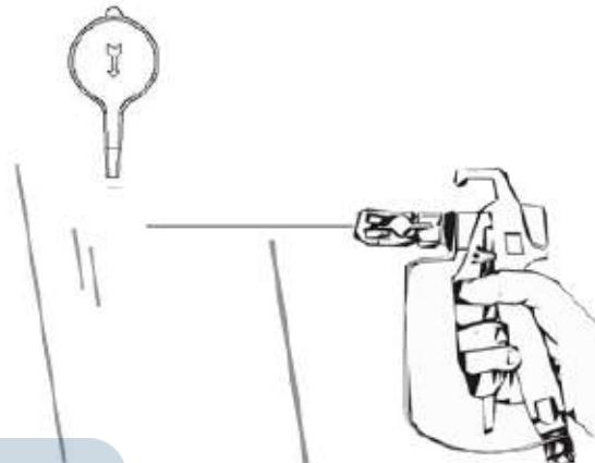
4. Lassen Sie den Abzug los und verriegeln Sie die Pistole. Drehen Sie die Spitze um, sodass der Pfeil wieder nach vorne zeigt (Position Sprühen). Entriegeln Sie die Pistole und setzen Sie das Sprühen fort.
