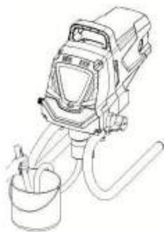
2. Tourner le bouton PRIME / SPRAY sur PRIME. Brancher le pulvérisateur. Mettre l'interrupteur sur ON (I).
