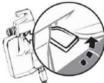
Um die Pistole zu verriegeln, drehen Sie die Abzugssperre nach vorne und leicht nach unten, bis sie stoppt.
