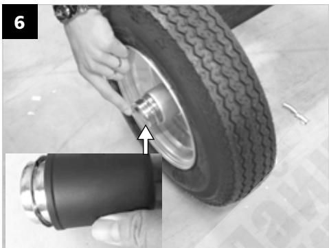
**HU** Kerekek: Csúsztassa a kereket a fél tengelyre (szelleppel kifelé). Szerelés közben ügyeljen arra, nehogy a belső csapágy kiessen! Helyezze fel a Ø20 alátétet, tekerje fel a M20x1,5 anyát és biztosítsa sasszeggel. Végül tegye fel a tengely burkolatát. A keréksapágy burkolatának felhelyezéséhez használja a fekete műanyag tokot. A tokot húzza fel a burkolatra és gumikalapáccsal ütésekkel rögzítse a kerékre. A másik oldalon ugyanígy járjon el.
