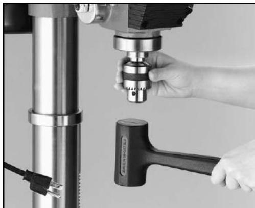
Ahora inserte el eje portabrocas MK3 en el eje del taladro y gire lentamente hasta que "encaje". Golpear ahora con cuidado el portabrocas en el eje.
