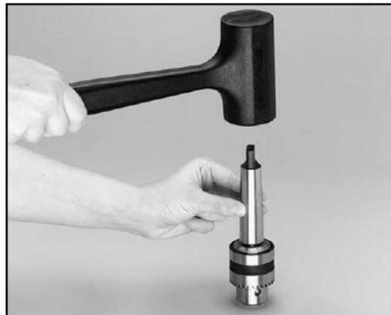
Mit dem Bohrfutterschlüssel die Spannbacken ganz im Bohrkopf versenken! Bohrfutter und MK3 Aufnahme wie in der Abbildung dargestellt zusammenstecken, mit einem Gummi- oder Holzhammer (verwenden Sie niemals einen Metallhammer!) vorsichtig darauf klopfen.
