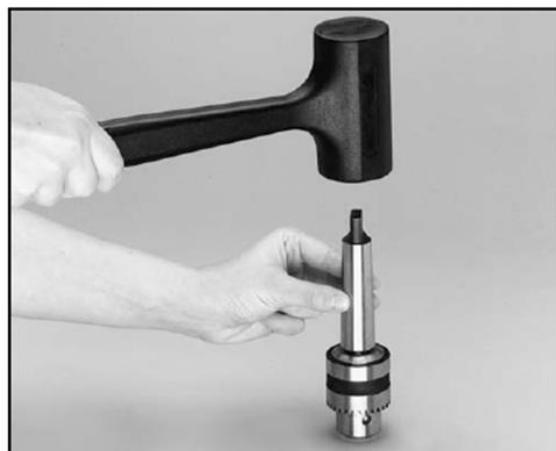
Avec la clé de mandrin, les mâchoires sont complètement immergées dans la tête de perçage. Le mandrin et l'arbre de mandrin MK3 s'assemblent comme indiqué dans l'image, tapez ensuite avec un marteau en caoutchouc ou en bois (ne jamais utiliser un marteau en métal!) avec précaution.
