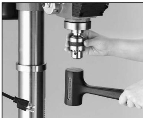
Stecken Sie nun die MK3 Aufnahme in die Bohrspindel und drehen Sie diese langsam bis diese „einrastet“. Schlagen Sie nun vorsichtig das Bohrfutter auf die Spindel.
