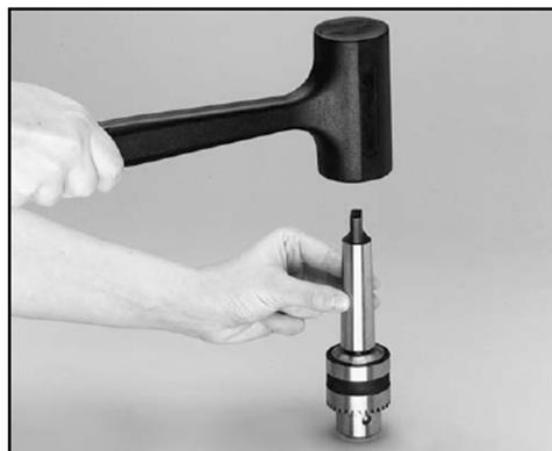
Con la llave del portabrocas, las mordazas se sumergen completamente en el cabezal del taladro. El portabrocas y el eje portabrocas MK3 se juntan como se muestra en la imagen, y golpéelo con un martillo de goma o de madera (inunca utilice un martillo de metal!) con cuidado.
