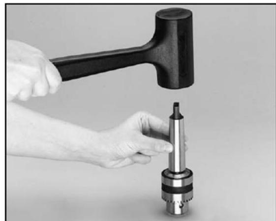
Draai de klauw met de boorholdersleutel compleet in de boorkop! Booropname en MK3 opname zoals op de afbeelding weergegeven bijeensteken en met een rubber of houten hamer (gebruik nooit een metalen hamer) voorzichtig erop hameren.
