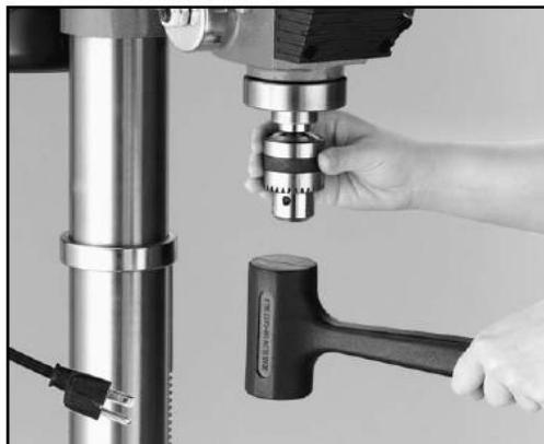
Maintenant, insérez l'arbre de mandrin MK3 dans l'arbre de perçage et faire tourner lentement jusqu'à ce qu'il "s'enclenche".
