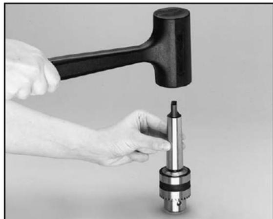
Sänk ned spännbackarna helt i borrväderstödet med chucknyckeln! Koppla ihop borrväder och MK3 upptagning som på bilden, och knacka försiktigt på dem med en gummi eller trähammare (använd aldrig en metallhammare!).
